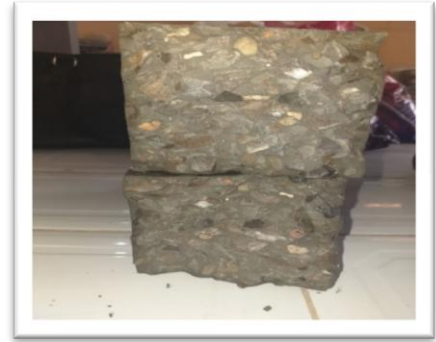
Figure II-20 : L'éprouvette après la rupture du béton
