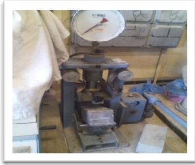
Figure II-19 : Machine de l'essai de flexion
