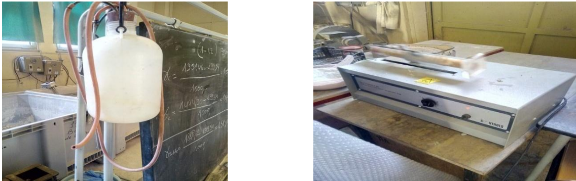
Figure II.4 essais de l'équivalente de sable
