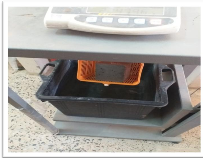
Figure II-16: Essai de la pesée hydrostatique.
