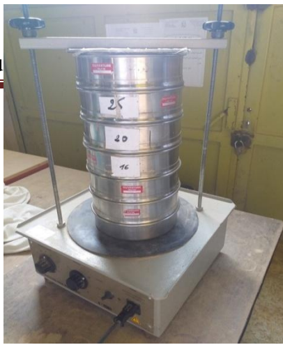
Figure II-6 : l'analyse granulométrique de gravier 7/15 de ain_touta
