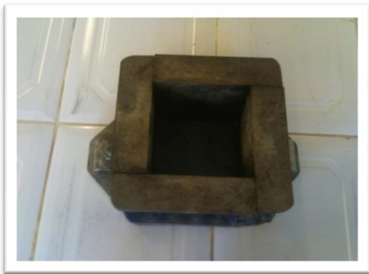
Figure II-12 : moule pour éprouvette cubique (10*10*10 cm)
