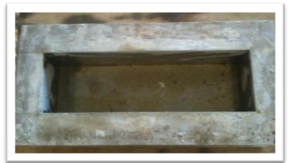
Figure II-13 : moule pour prismatic (10-10-40)
