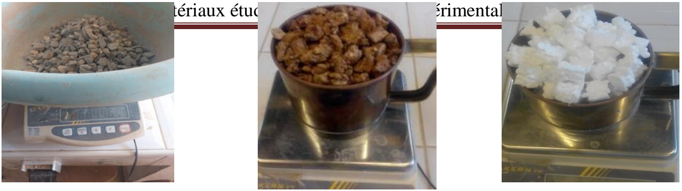
Figure II-10 : la masse volumique apparente de granulats légers
