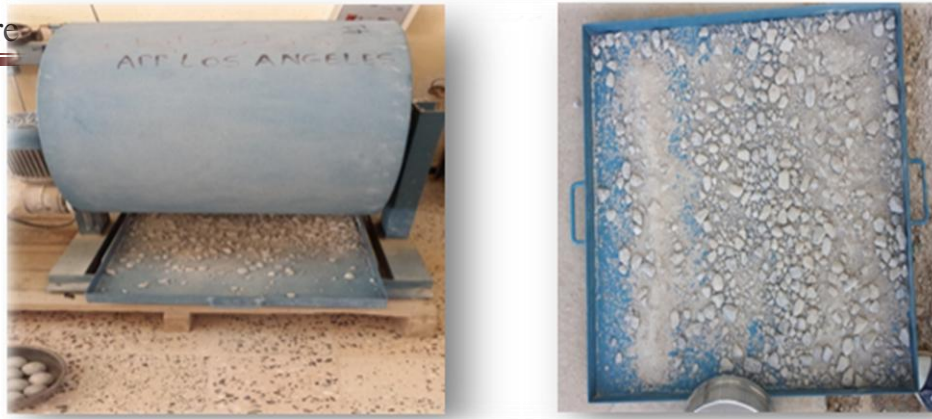
Figure II-8 : L'essai de Los-Angeles
