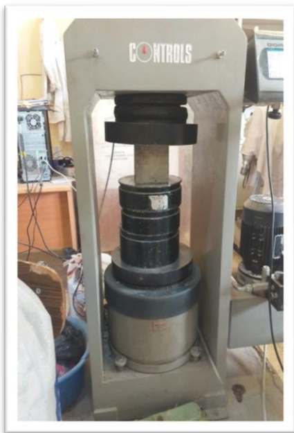
Figure II-17 : Machine de l'essai de la compression. Figure II-18 éprouvette cubique
