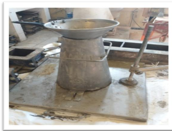
Figure II-15 : Essai d'affaissement « Slump-test »
