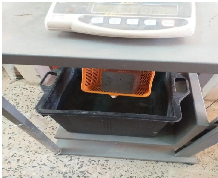
Figure III-03 : masse volumique des bétons en Kg/m 3 .
