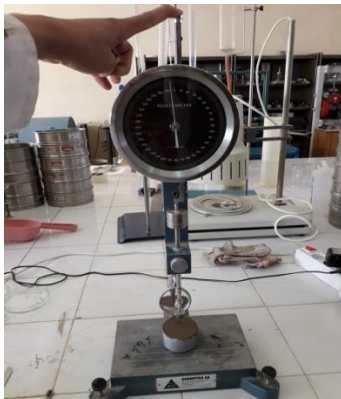
Figure 2-9 : Noter sa nouvelle position l'enfoncement h doit être comprise entre 12 et 25 mm.
