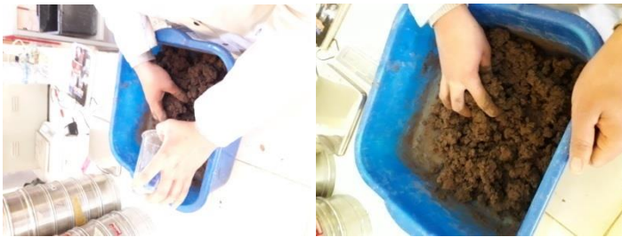
Figure 2-34: On ajoute une certaine quantité d'eau proportionnelle on poids d'argile utilisé.
