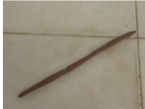
Figure 2-10: Rouler la boulette sur une plaque lisse de façon à partir de obtenir un rouleau de 3mm de diamètre et de 10 cm de longueur.
