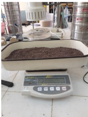
Figure 2- 32: On prend 2 kg d'argile.
