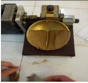
Figure 2-8 : La pâte recouvre le fond de la coupelle, sauf sur une partie d d'environ 3cm.
