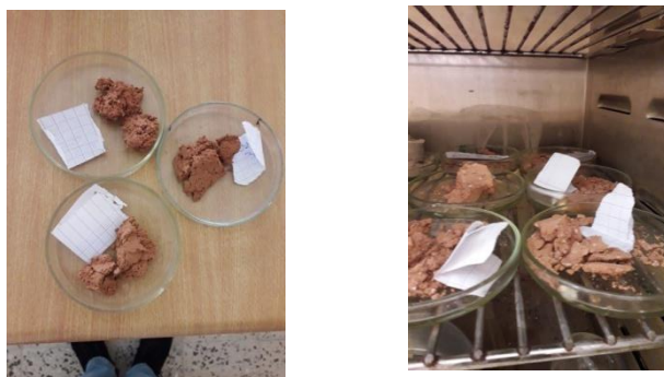
Figure 2-38: Déterminer la teneur en eau et le poids volumique \gamma_d .
