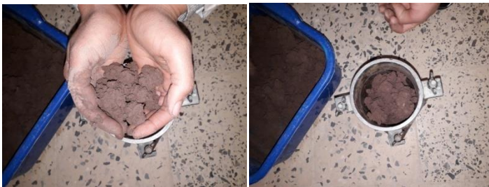
Figure 2-35: On remplit le moule Proctor normalisé en trois couche on compacte l'aide de la dame Proctor normal en 25 coup.
