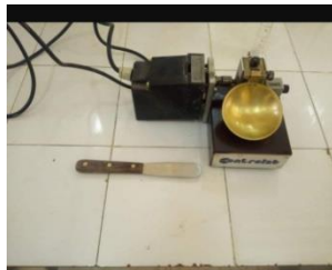
Figure 2-1: Un appareil de casagrande se compose
