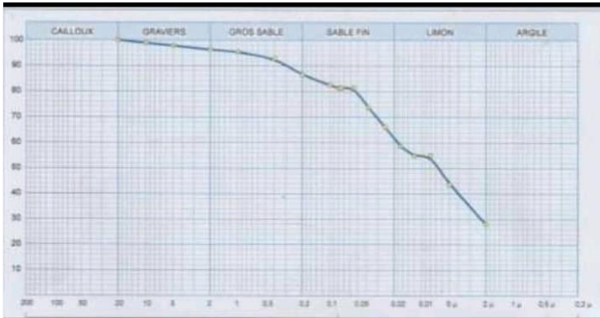
Figure 3-5 : courbe analyse granulométrique de argile sabaa mkataa.
