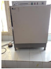
Figure 2-13 : Une étuve ventilée à température réglable à 105°. Un minimum de 3 bacs.
