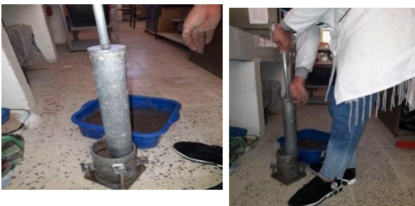
Figure 2-36: Place de la 2 ème et 3 ème couchent.
