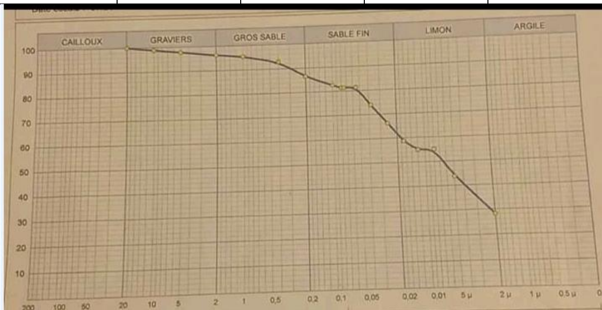
Figure 3-4 : courbe analyse granulométrique de argile El-kantra.
