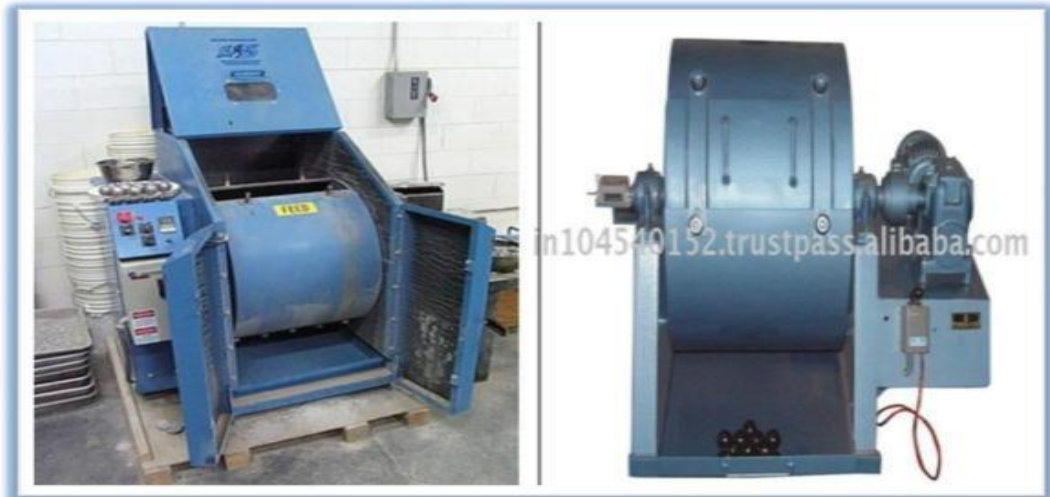
Figure. VI.8. l’essai los Angeles
