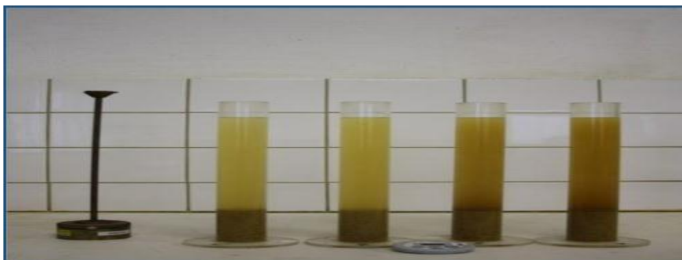
Figure.VI.5. L'essai équivalente sable
