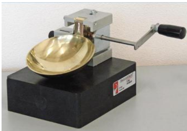
Figure.VI.4. l'appareil de casagrande
