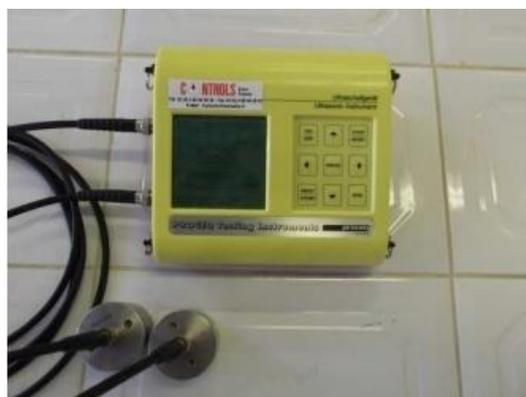
Figure II. 15. Ultrason de PUNDIT.
