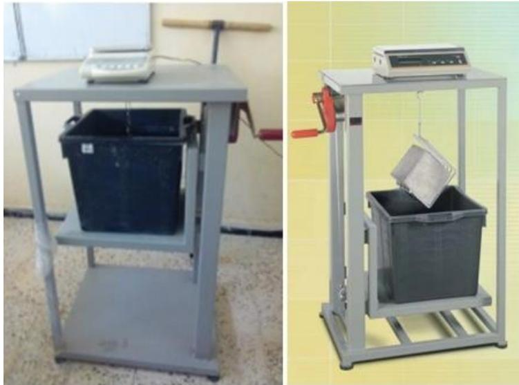
Figure II. 16. Dispositif de la mesure de la porosité du béton.
