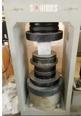
**Figure II. 14.** Eprouvette mise en place sur la presse hydraulique.
