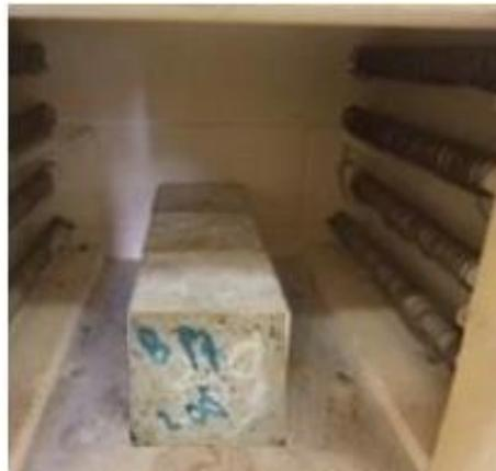
**Figure II. 13.** Disposition des éprouvettes dans le four.
