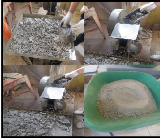
Figure II. 3: Sable recyclé 0/5 produit par le concassage de béton
