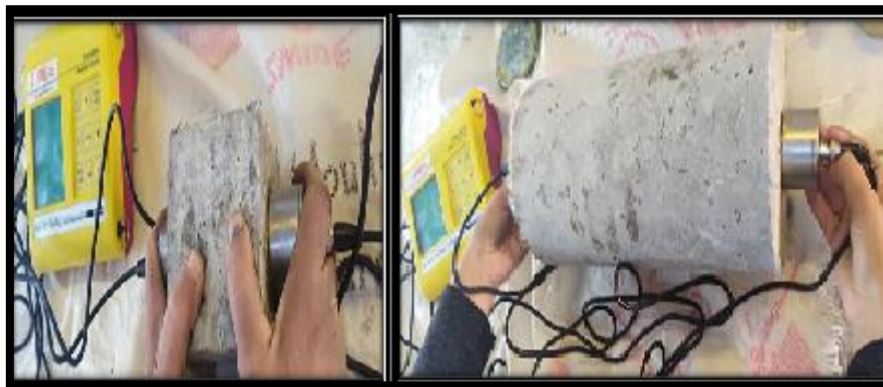
Figure III. 6: mesures à l'ultrason d'éprouvettes cubiques (10×10×10) cm 3 et cylindrique (16 × 32)cm 2 .
