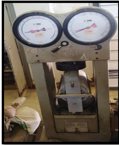
Figure II. 11 : Dispositif pour mesurer la résistance à la traction fendage
