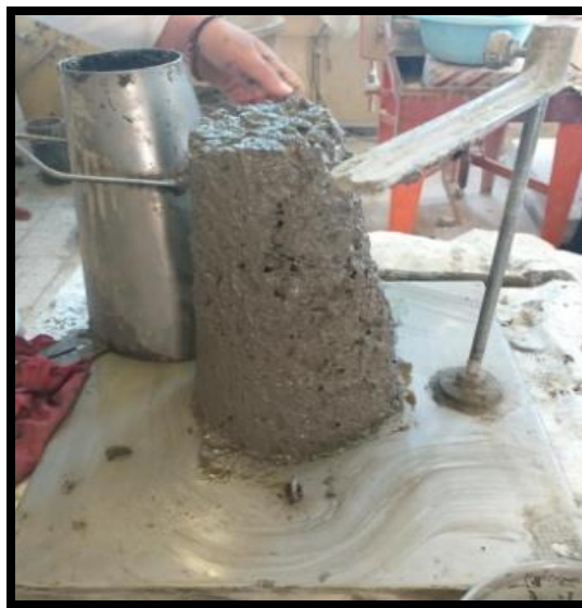
Figure II. 6 : l'affaissement de cône d'Abrams d'un béton.
