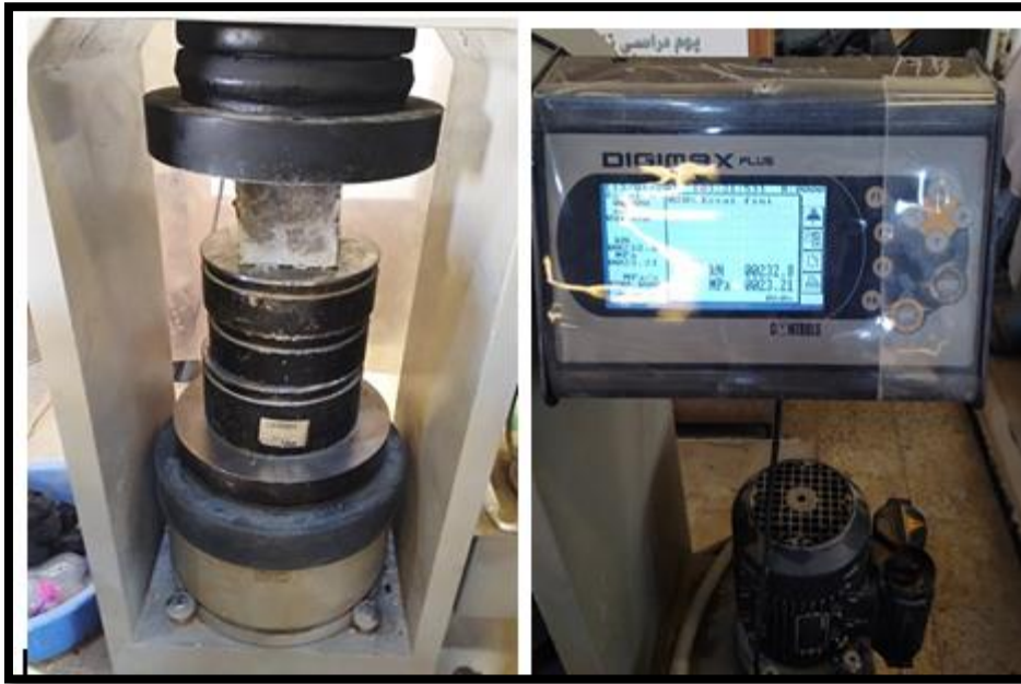
Figure II. 10 : La machine pour essai de compression et affichage de la résistance.
