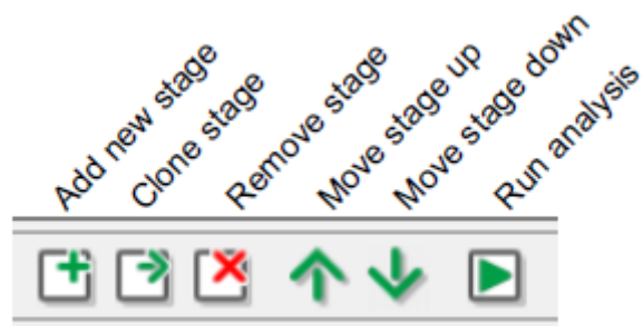
Figure 16: Boutons de contrôle de Stage Manager (K Krabbenhoft, et al 2016).
