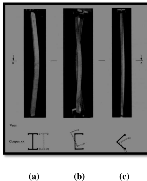
Fig. I.16 Flambement des poutres droites comprimées.
