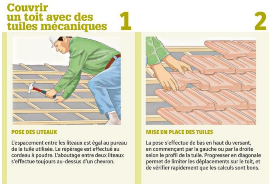
Figures 111,112 : étapes la couverture de la toiture en tuile.
