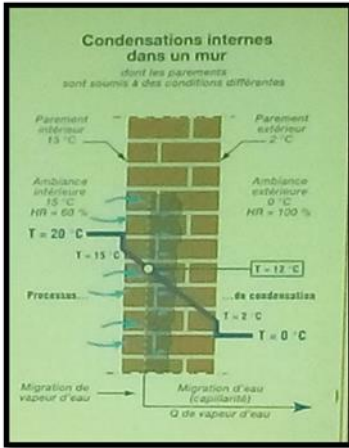
شكل46: توضح كيفية حدوث ظاهرة التكثف
