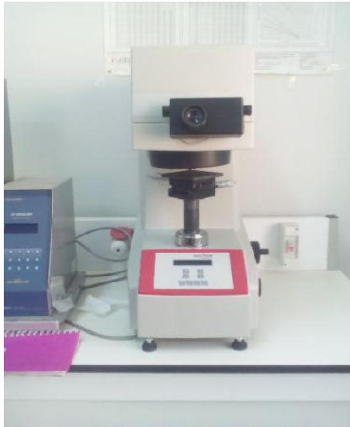
**Figure III.8.** Microduromètre de type ZWICK.
