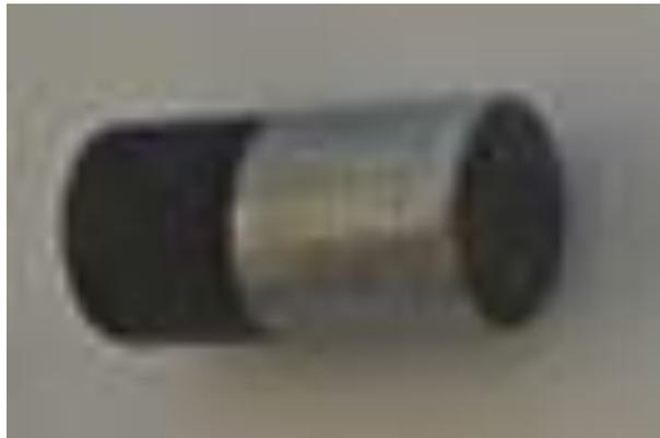
**Figure III.2.** Échantillon soudé par diffusion (Acier/Aluminium).
