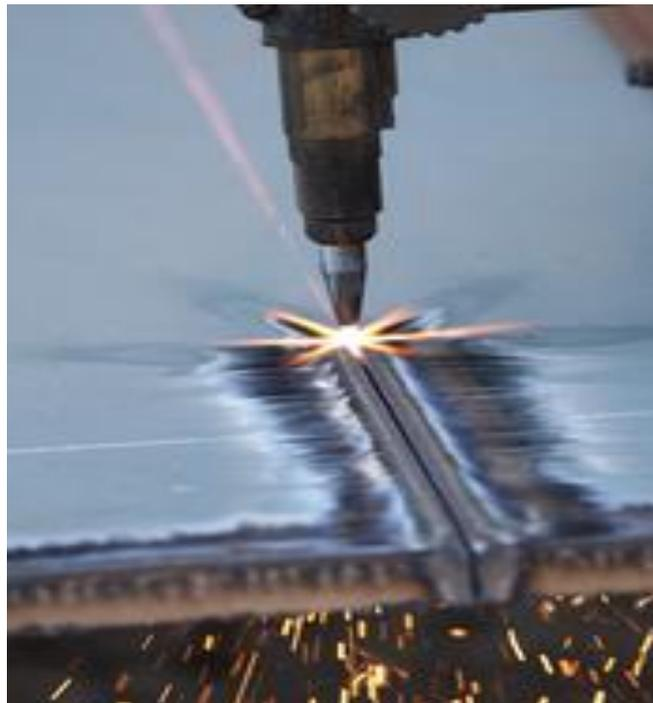
**Figure I.2.** Le soudage laser [6].
