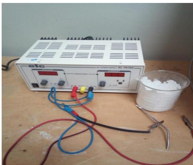
**Figure III.4.** Montage de l'attaque électrolytique.
