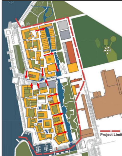
Fig.II.41 : la direction d'écoulement des eaux pluviales.
