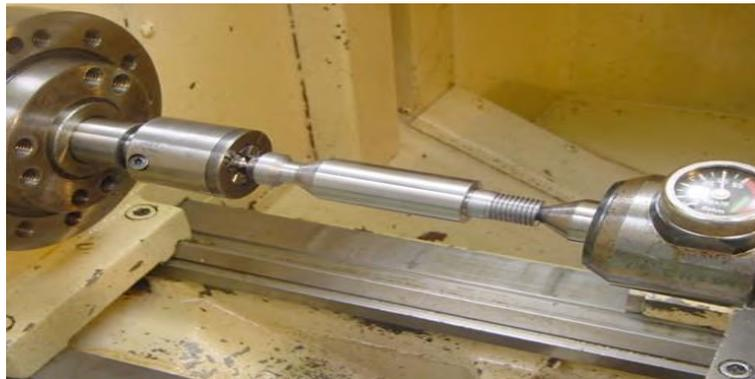
**Figure II.7.** Montage entre pointes" sur tour à commande numérique [8].
