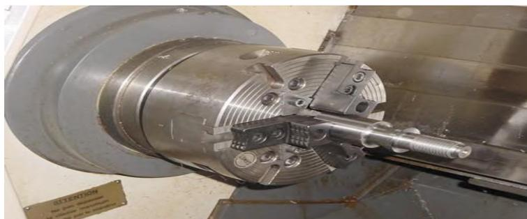
Figure II.5. Montage en l'air" : mandrin à 3 mors concentriques sur centre de tournage [8].
