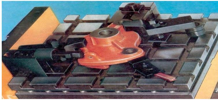
Figure II.9. Montage d'usinage modulaire [8].
