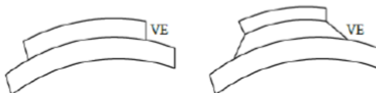
Figure I.13 : Amortissement avec une couche viscoélastique collée à une plaque [21].
