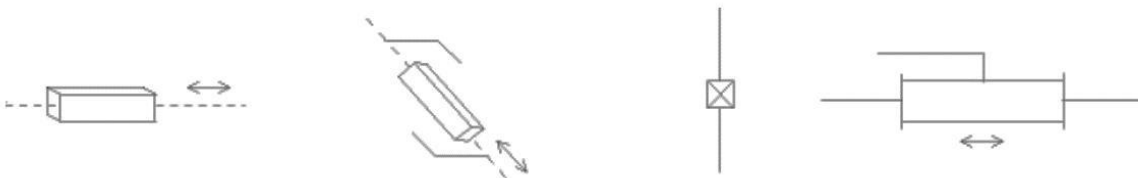
Fig. I.9. Représentation d'une articulation prismatique [10]
