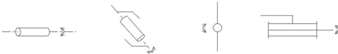
Fig. I.10. Représentation d'une articulation rotoïde [10]
