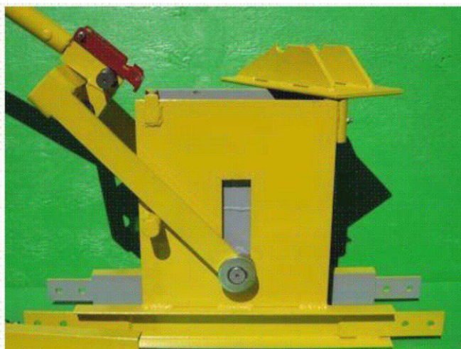
Fig. I.4. La presse à blocs Fernco MP-612
