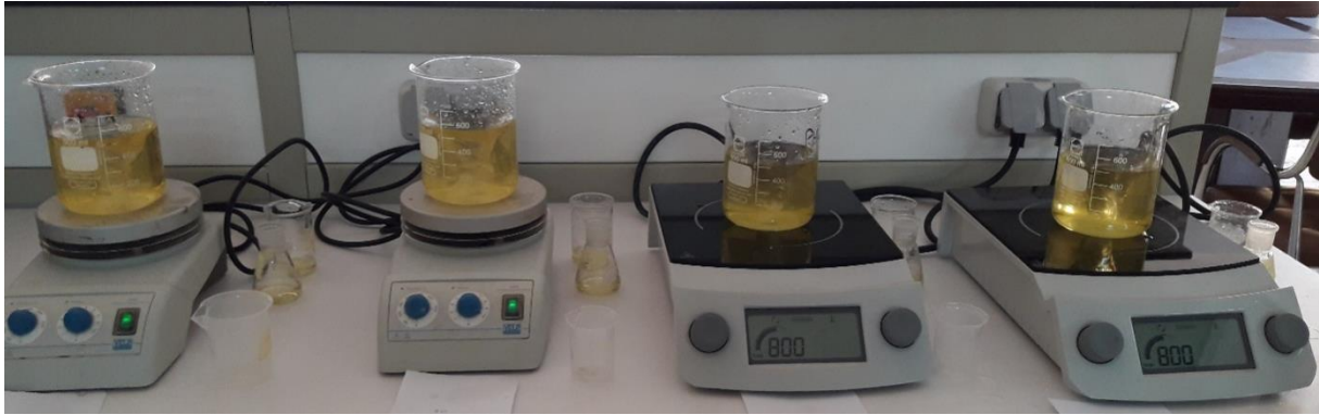
Figure III. 8 : Dispositif expérimental des essais d'adsorption.
