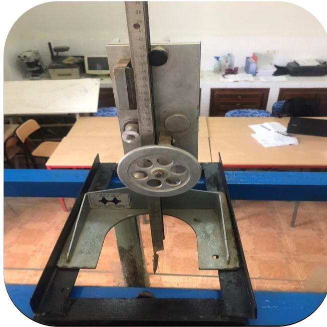
**Figure (1.3):** Photographie du limnimétrie à vernier
