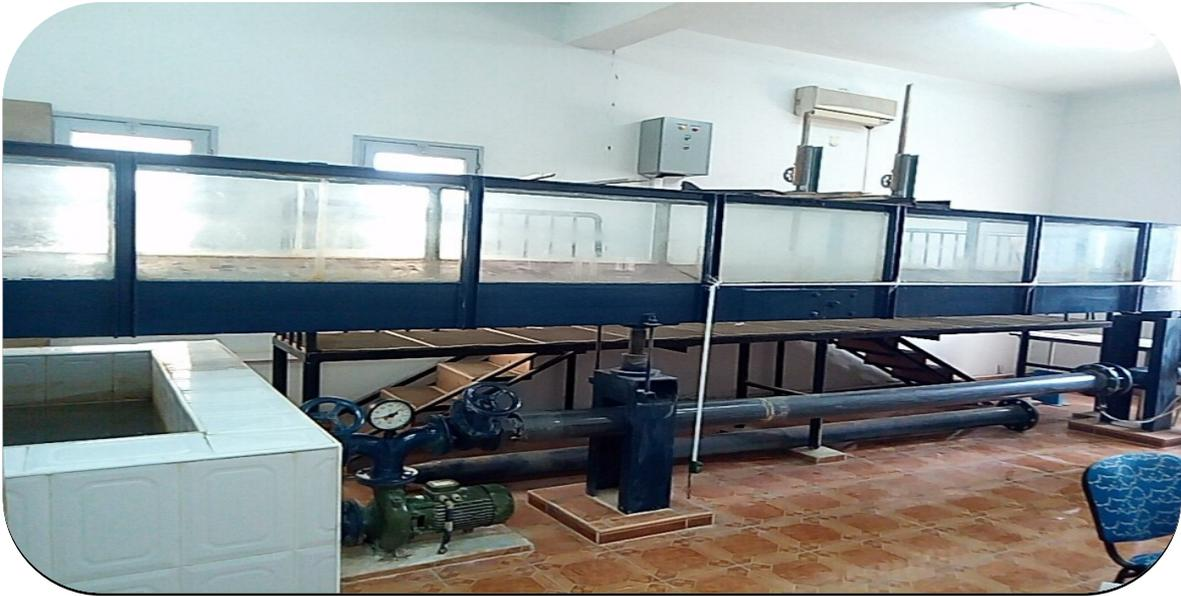
**Figure (1.2):** Photographie du modèle expérimentale du canal non rectangulaire
