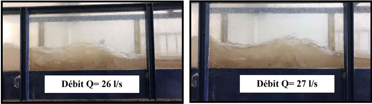
Figure (2.6): Ressaut hydraulique évoluant dans le canal non-rectangulaire (ouverture 8.5 cm).
