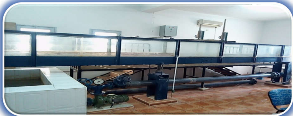
Figure (1.1): Photographie du modèle expérimentale du canal non rectangulaire.
