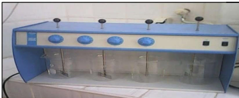
**Figure 12** : Essai « Jar-Test » flocculateur de laboratoire CRSTRA (Hecini, 2014)
