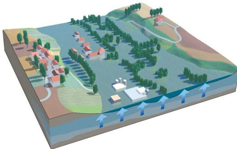
Figure I.3: Affleurement de la nappe et inondation des terrains bas
