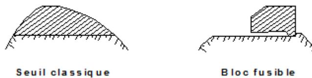
Figure I.24 bloc fusible placé sur un seuil après un arasement.
