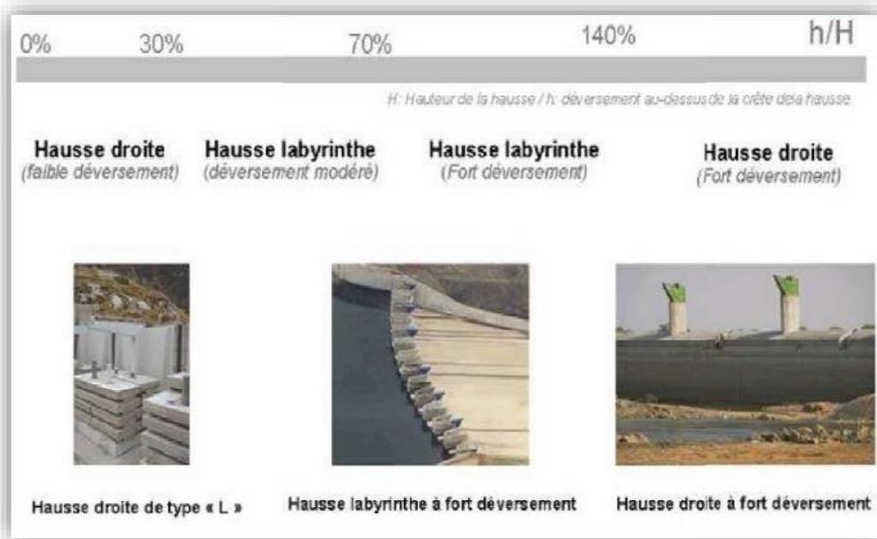
**Figure I.8** type de hausses utilisées en fonction du rapport h/H.
