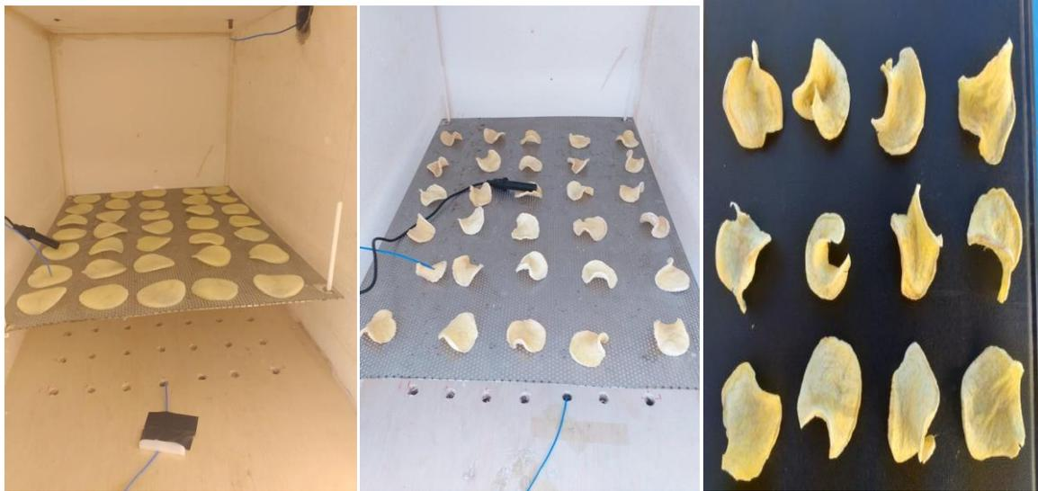
**Figure (III-15):** Tranches de pomme de terre humides et séchées de 2 mm d'épaisseur, 40mm de diamètre, le débit 0,011 Kg /s, hauteur de la grille 4,8 cm.
