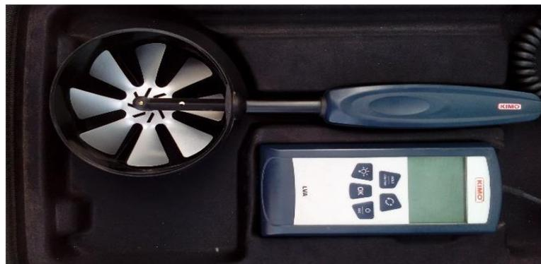
**Figure (III-12):** Un anémomètre numérique (modèle KIMO-LVA)
