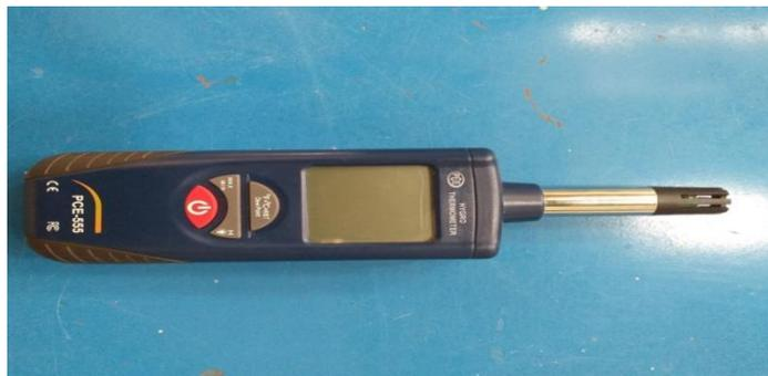
**Figure (III-10):** Hygromètre (modèle PCE-555).
