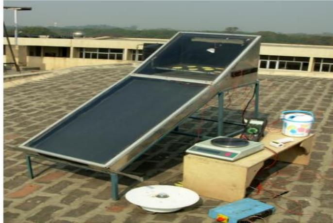
**Figure (II-32)** : Installation expérimentale pour le séchage solaire en mode mixte par convection naturelle.
