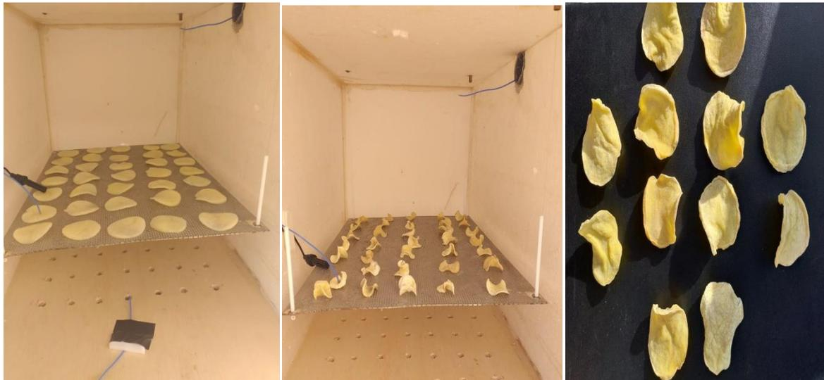
**Figure (III-17):** Tranches de pomme de terre humides et séchées de 2 mm d'épaisseur, 40mm de diamètre, le débit 0,024 Kg /s, hauteur de la grille 4,8 cm.
