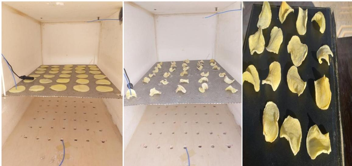
**Figure (III-18):** Tranches de pomme de terre humides et séchées de 3 mm d'épaisseur, 40mm de diamètre, le débit 0,024 Kg /s, hauteur de la grille 6,8 cm.
