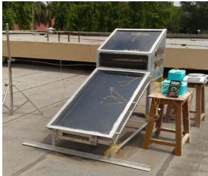
**Figure (II-13):** Séchoir solaire à mode mixte à convection naturelle conçu en interne.
