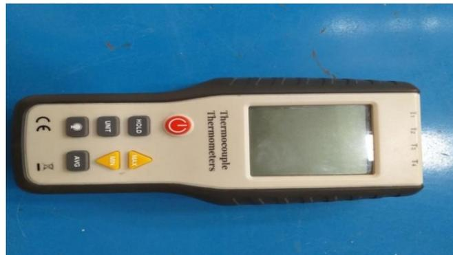
**Figure (III-9):** A thermocouples de type k.
