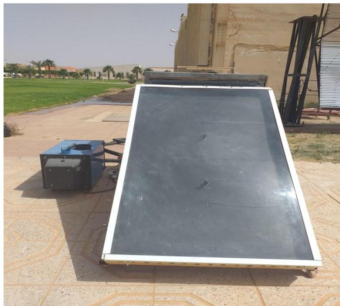
**Figure (III-3):** Configuration expérimentale (capteur solaire avec chambre de séchage).
