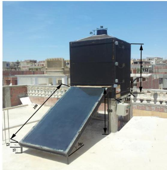
Figure (II-19) : Le séchoir solaire expérimental.
