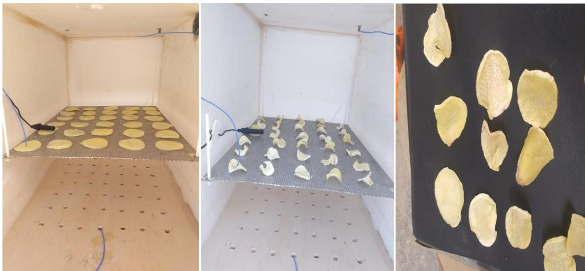
**Figure (III-16):** Tranches de pomme de terre humides et séchées de 3 mm d'épaisseur, 40mm de diamètre, le débit 0,011 Kg /s, hauteur de la grille 6,8 cm.
