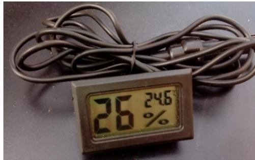
**Figure (III-8):** Un thermomètre-contrôle (modèle TPM-10).
