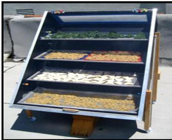
Figure (I-10): Sécheurs solaires directs (Site web).
