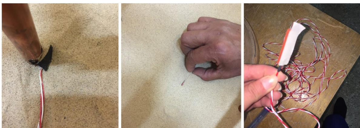
Figure III.14. Installation des sondes PT 100 à 04 fils sur les parois des tubes et dans le sable.
