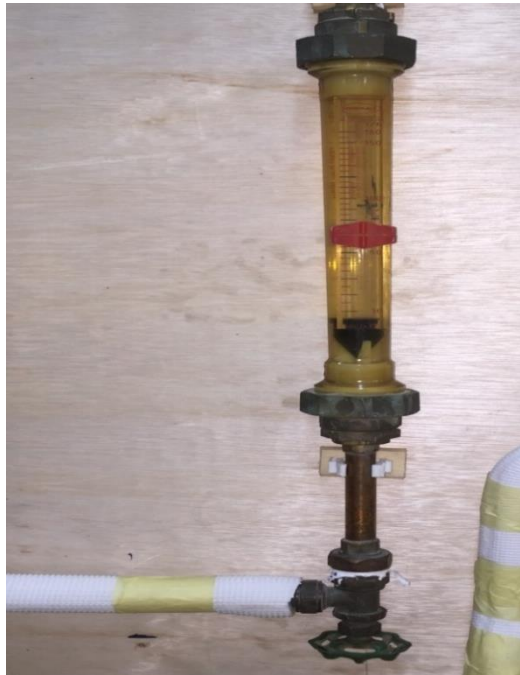
Figure III.11. Débit mètre à flotteur gradué de 0 à 160 l/h.
