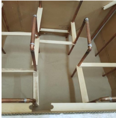
Figure III.5. Emplacement de l'échangeur serpentin à l'intérieur de la cuve.
