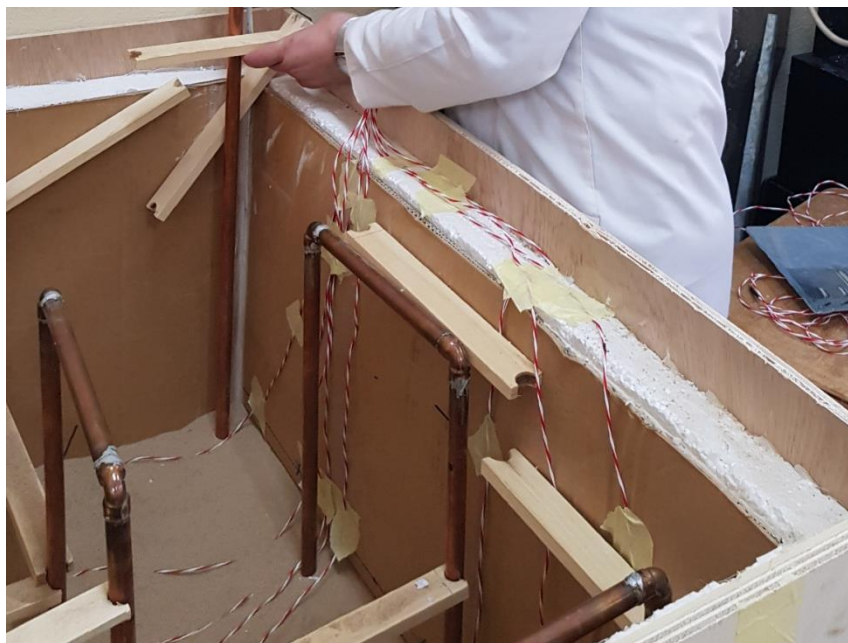
Figure III.13. Thermomètres PT 100 à 04 fils fixés sur les parois et au alentour des tubes dans le sable à une hauteur de 50 cm à partir du fond de la cuve
