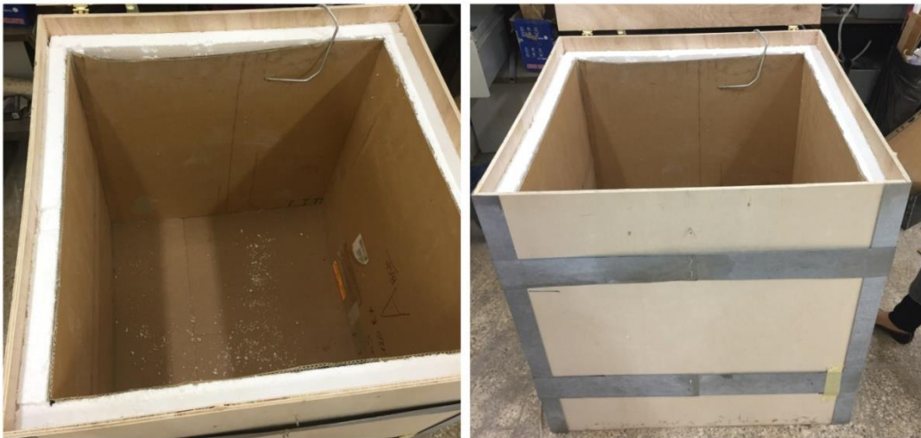
Figure III.4. Cuve de stockage munie d'une double couche d'isolation thermique en polystyrène et carton ondulé.
