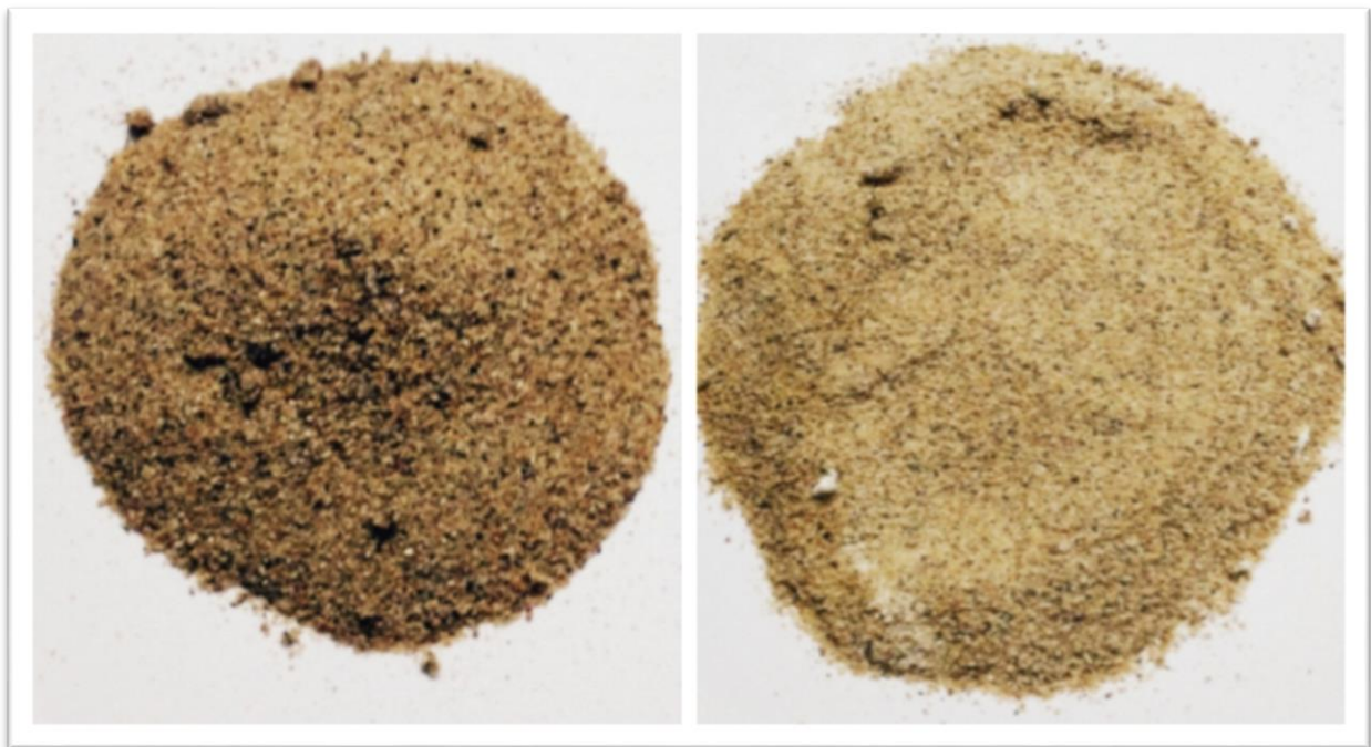
Figure I.6. Échantillon de sable de rivière avant et après chauffage. [13]
