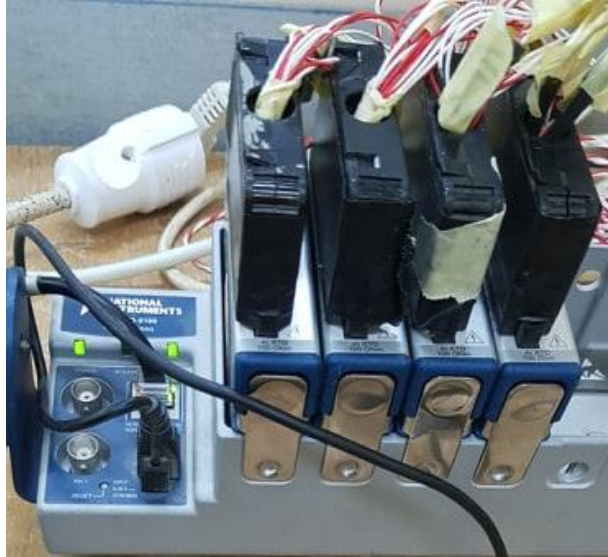
Figure III.15. Châssis NI Compact DAQ-9188 Ethernet à 8 emplacements avec modules supporte sondes de température PT-100 à 04 fils
