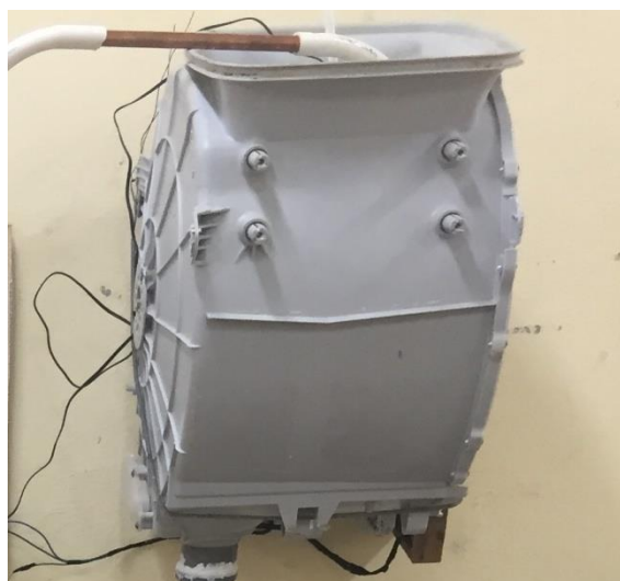
Figure III.8. Cuve en PVC thermorésistant de chauffage de l'eau.
