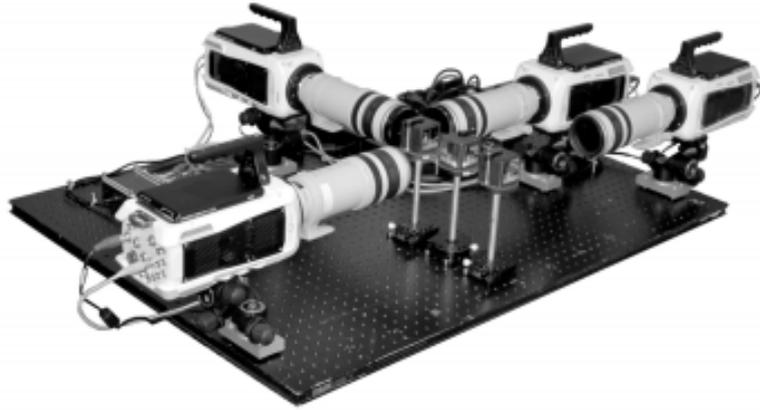
FIGURE 1.14 – – La visualisation d'une seule scène avec plusieurs capteurs d'images via un diviseur de faisceau.[20]
