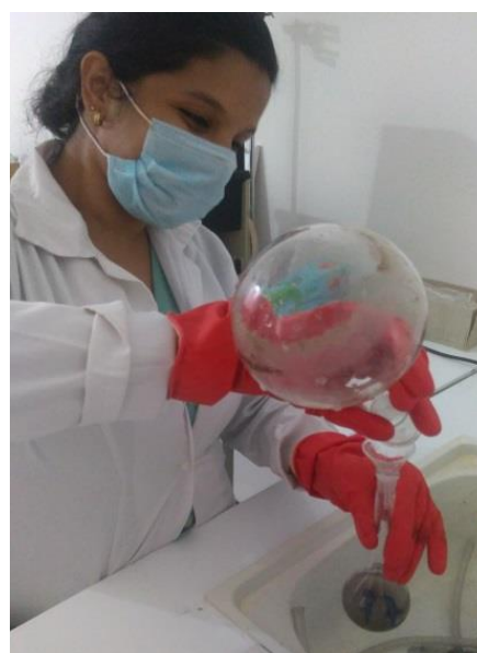
Annexe 18: Dosage de l'azote total du compost "Distillation" (l'ajoute de solution préparée dans une fiole).
