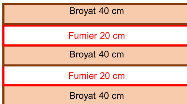
Annexe 14: les couches alternées de Broyat avec le fumier pour andain de compost.
