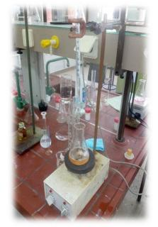
Figure 1: titration montage
