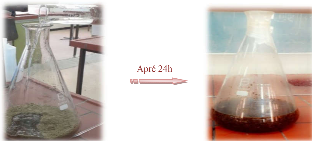
Figure III.3 : Macération de la matière végétale
