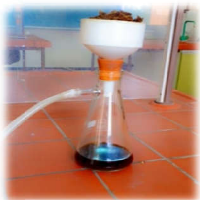
Figure III.4 : La Filtration sous vide
