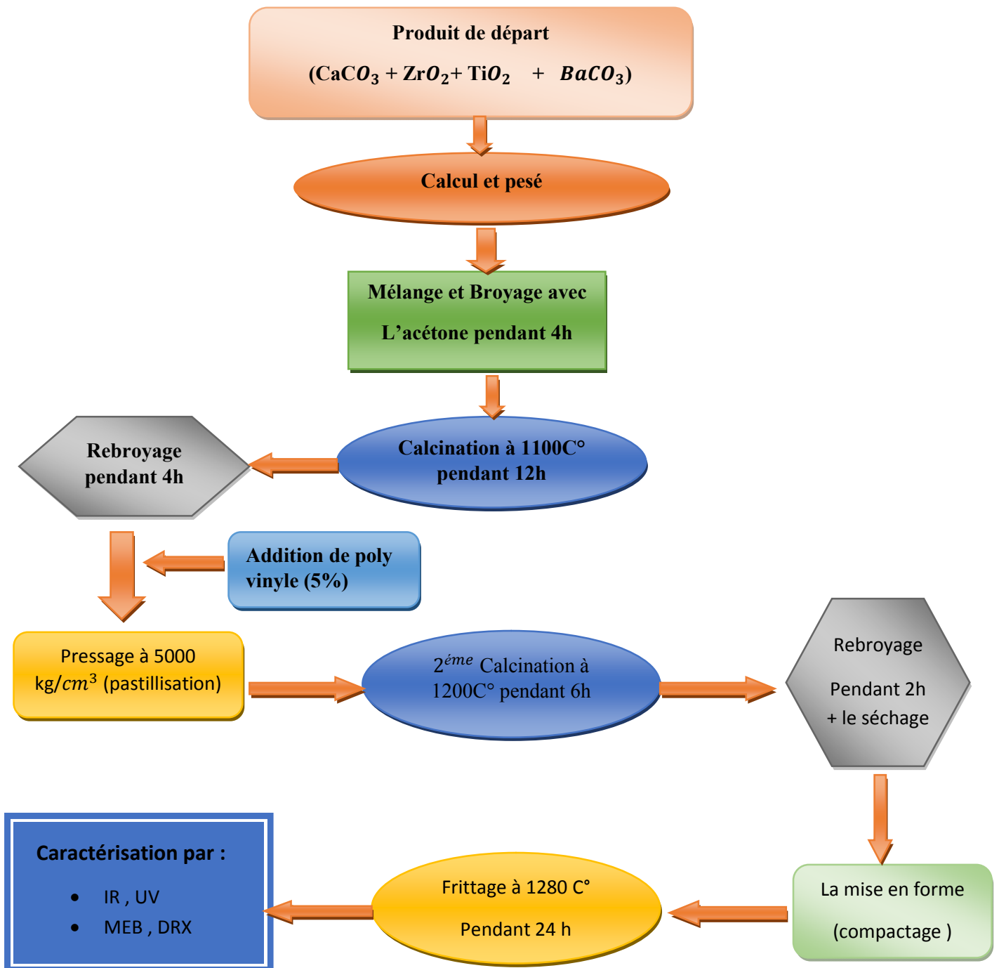
Figure II.2 : Les principales étapes de synthèse de la solution solide Ba_xCa_{1-x}(Zr_{0.20}Ti_{0.8})O_3 .
