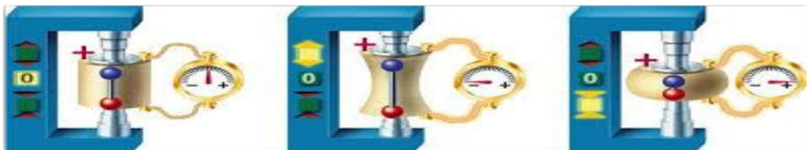
Figure I.6: Effet piézoélectrique directe [13].
