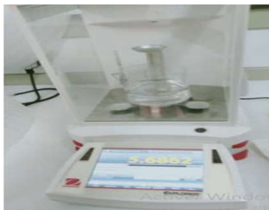
Figure II.25: Balance électrique basée sur la technique d'Archimède poussée.
