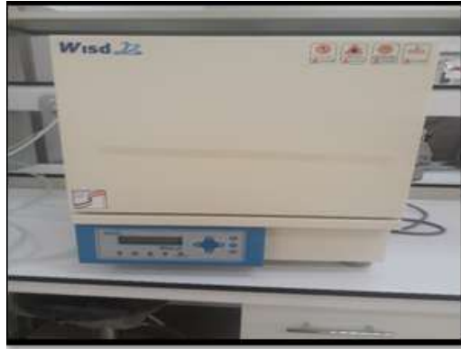
Figure II.23: Four à moufle daihan scientific FH-05 digital, laboratoire de physique des couches minces et application (LPCMA), Université de Biskra.
