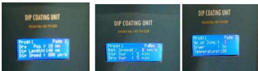
Figure II. 22 : Les étapes de réglage de l'appareil dip-coating.
