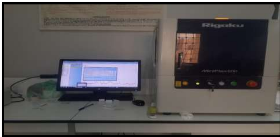
Figure II.13: l'appareil de diffractomètre du type Rigaku Miniflex 600 X. [21]
