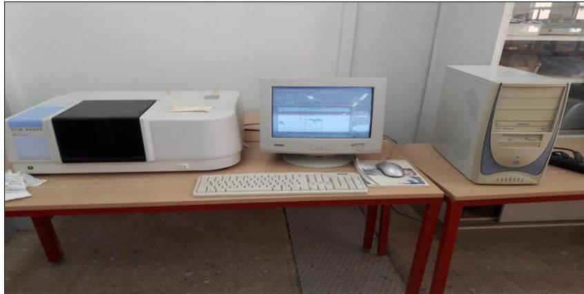
**Figure II.8:** Spectromètre infrarouge à transformée de Fourier FTIR.
