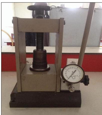
**Figure III.6:** la presse utilisée pour la préparation des pastilles.
