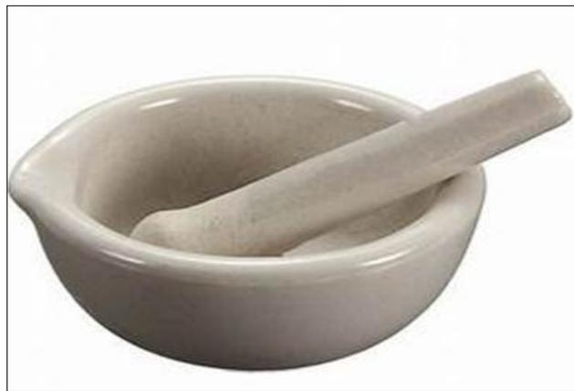
**Figure II. 2:** Mortier utilisé pour le broyage.
