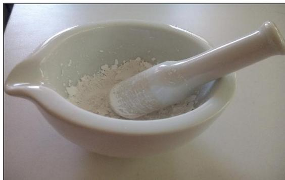
**Figure III.3:** Mélange et broyage des échantillons dans un mortier.
