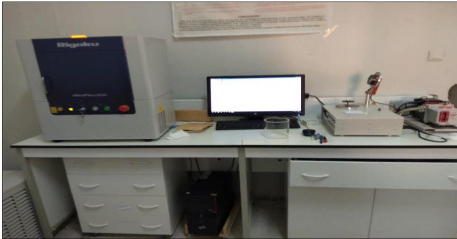
**Figure II.7:** Diffractomètre de type Miniflex600.
