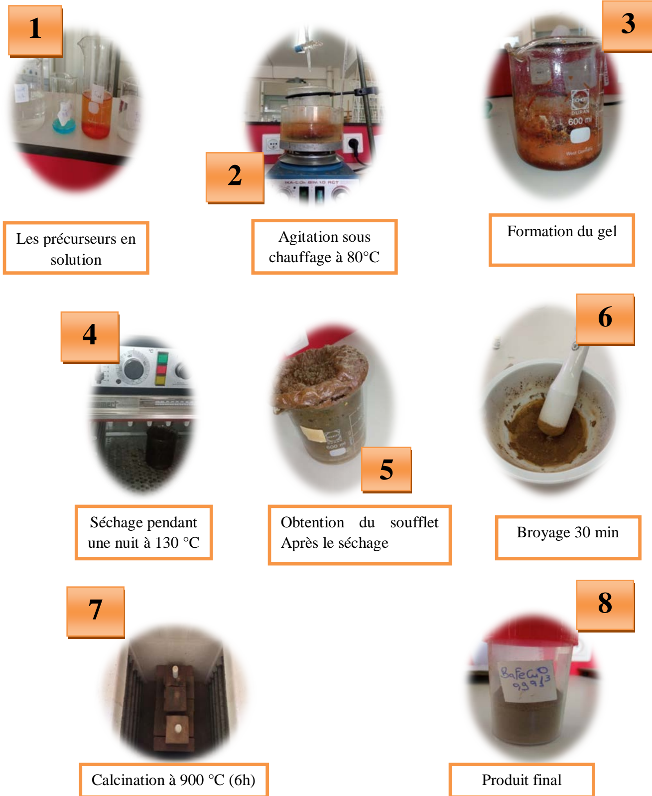
Figure III.2 : Les étapes de la synthèse de BaFe_{1-x}Cu_xO_3 par la méthode citrate.
