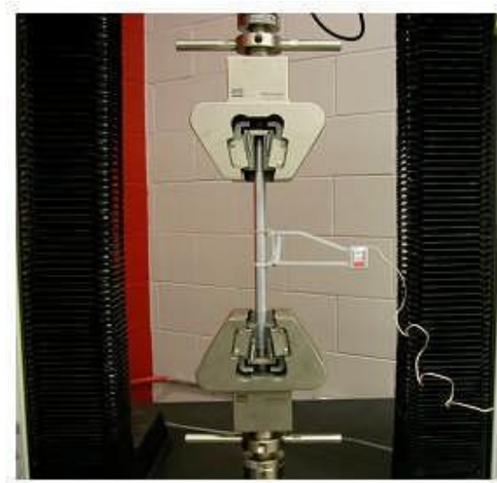
Figure III.2: La machine de traction Zwick/Roell (Z 100).
