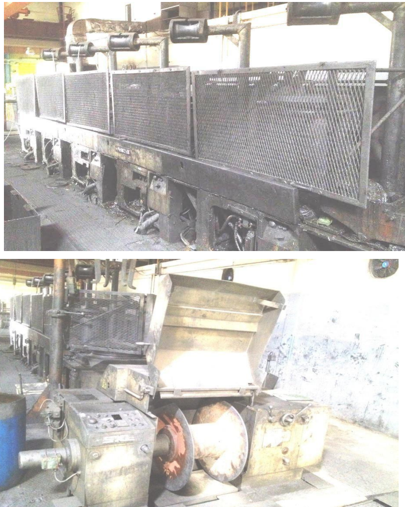
Figure II .7 : Machine de tréfileuses d'aluminium AGS (ENICAB Biskra).
