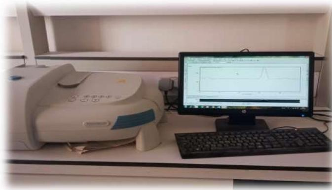
**Figure II.12.** Spectrophotomètre à UV-visible d'université de Biskra.
