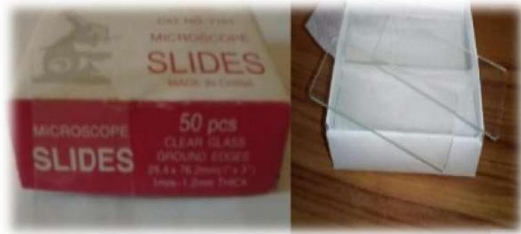
**Figure II.6.** Le type de substrat utilisé.
