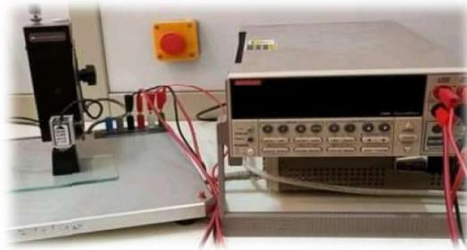
Figure II.16. Dispositif à quatre pointes d'université de Biskra.
