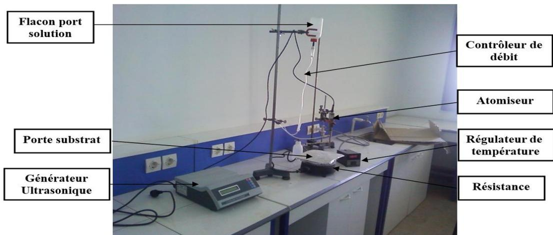
Figure II.1 : Le dispositif complet de déposition de couche mince par la technique de Spray ultrasonique de l'université Mohamed Khaider-Biskra.
