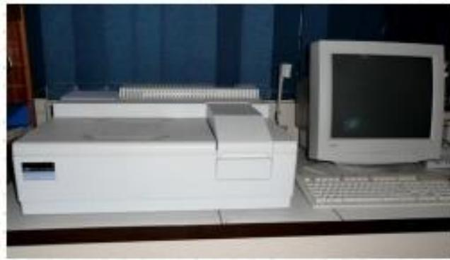
**Figure II.8:**Spectrophotomètre UV-Vis-PIR.
