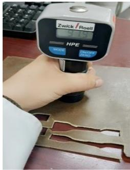
Figure 30: Test de la dureté Shore.
