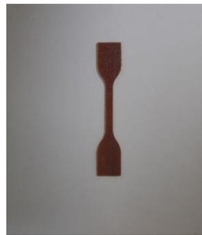
**Figure 25:** Découpage des éprouvettes.
