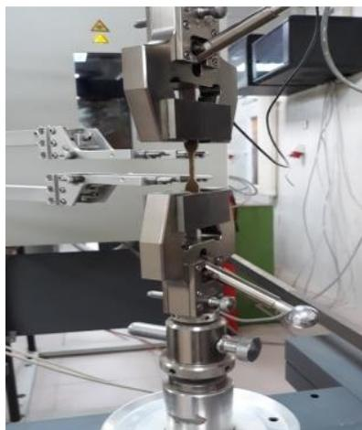
**Figure 27:** Éprouvette d'essai mise en place dans la machine de traction.
