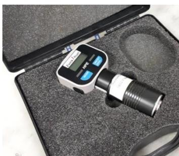
Figure 29: Duromètre Shore A.
