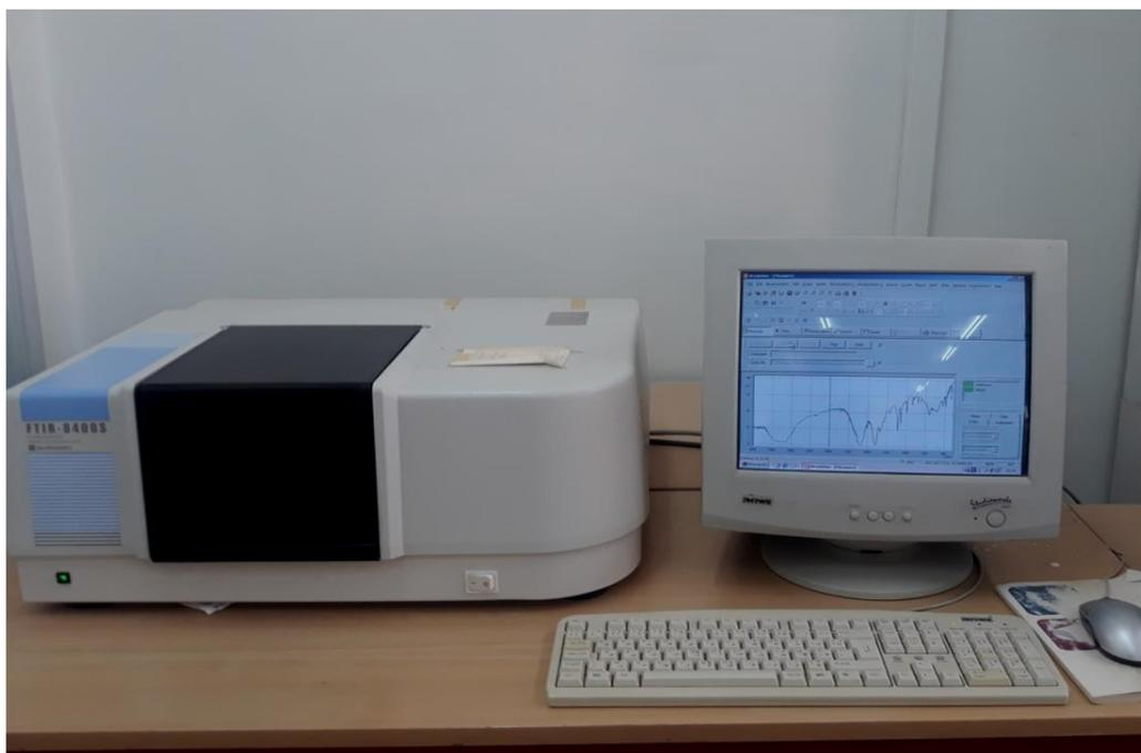
**Figure 19:** Spectrophotomètre à transformée de Fourier de type SHIMADZU FTIR-8400S.
