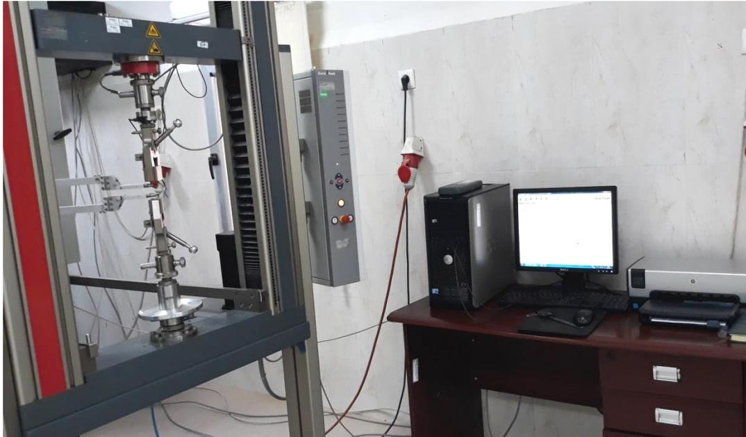
**Figure 22:** Machine de traction de type Zwick/Roell.
