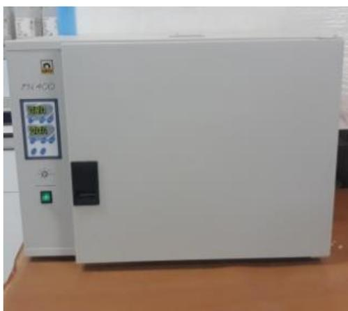
**Figure 31:** Séchage des éprouvettes dans l'étuve pendant 1 h à 80 °C.
