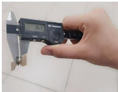
**Figure 26:** Mesure des dimensions de l'éprouvette.
