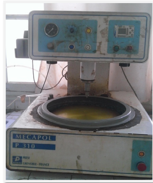
Figure II.4: Polisseuse mécanique de type PRESI MECAPOL P310 (Laboratoire de Génie Mécanique, univ -Biskra).
