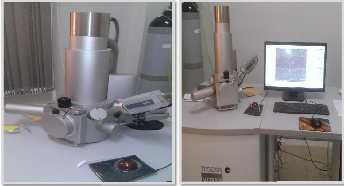
Figure II.11: Microscope électronique à balayage (Laboratoire de Physique des Couches Minces et Application Univ-Biskra)
