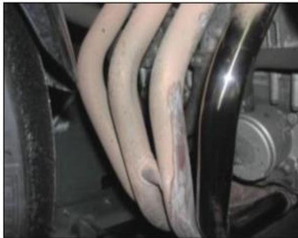
**Figure I. 1 :** Exemple de la corrosion d'un collecteur d'échappement. [7]
