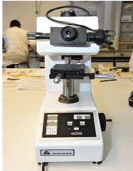
**Figure IV. 5 :** Dispositif utilisé pour la mesure de la microdureté.
