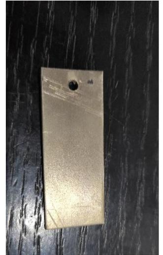
**Pièce revêtue****Figure IV. 2 : Nickelage chimique.**
