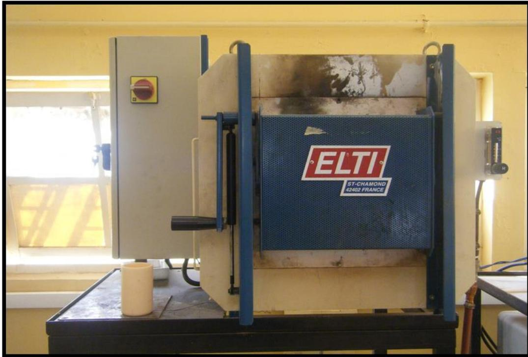
**Figure IV. 3 :** Dispositif utilisé pour les traitements thermiques (Four).
