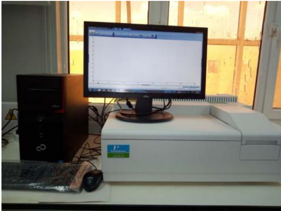
Figure II.8 : Spectrophotomètre UV-Vis Perkin Elmer lambda35.
