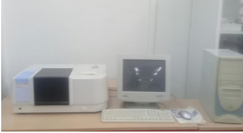
الشكل II.12 جهاز مطيافية الامتصاص للأشعة تحت الحمراء المزود بتحويل فورييه
