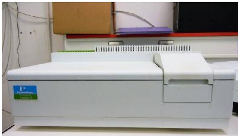
*Figure II.17 : Spectromètre UV-visible de type Perkin Elmer Lambda 35.*
