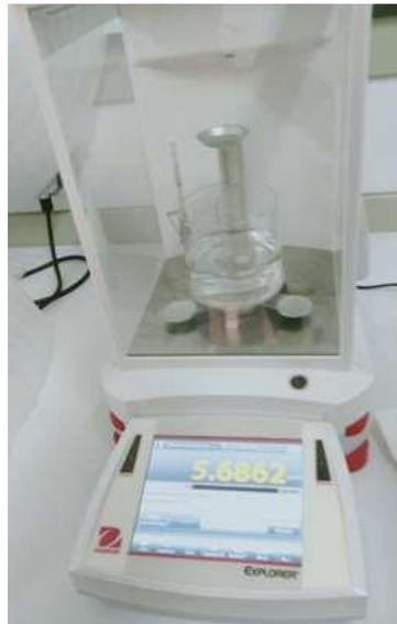
*Figure II.5 : Balance électrique couplée à l'instrument basé sur la technique de poussée d'Archimède.*
