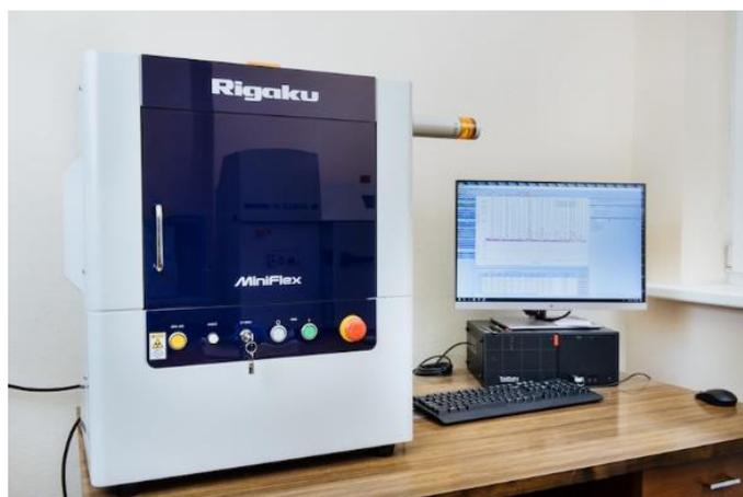
**Figure II.10 :** Diffractomètre Miniflex 600 en configuration (Bragg-Brentano) dite «  $\theta$ - $\theta$  ».
