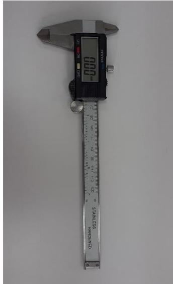
*Figure II.16 : Pied à coulisse électronique.*
