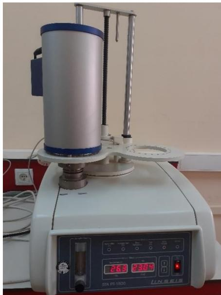
*Figure II.4 : Appareil Linseis STA PT-1600.*
