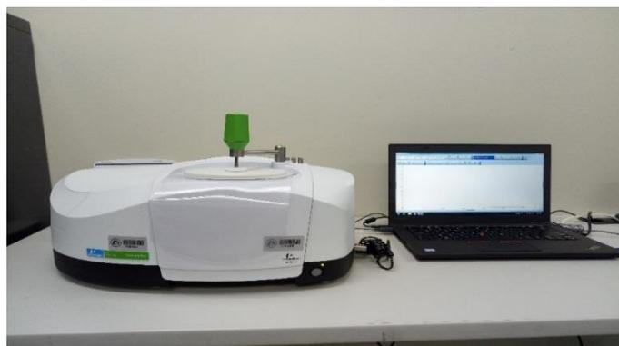
Figure II.13 : Spectromètre pour solide de type Perkin Elmer FTIR.
