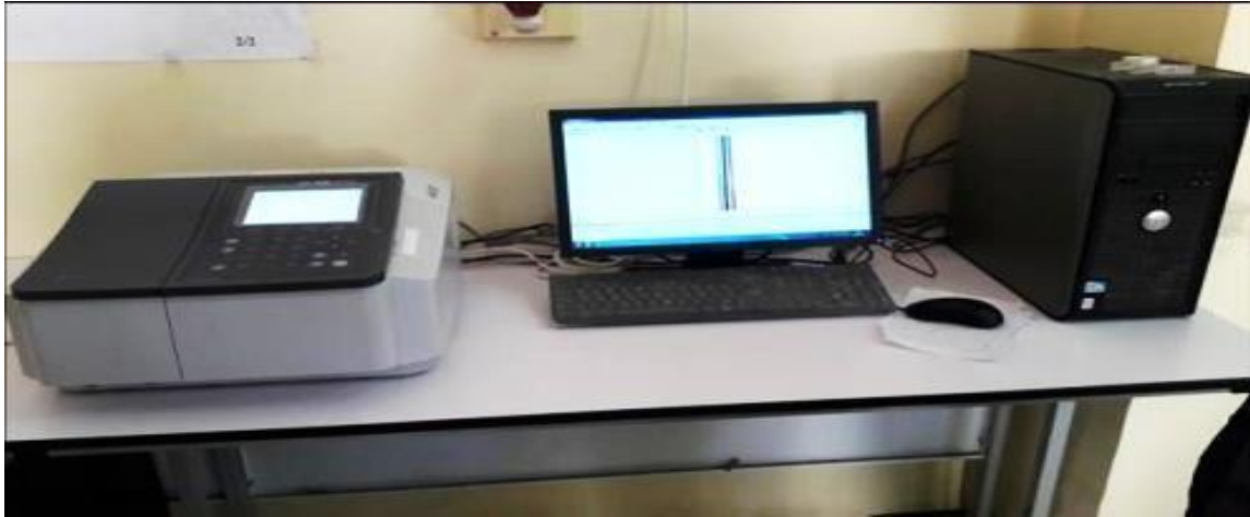
الشكل (II. 24) : جهاز التحليل الطيفي (UV-VIS).
