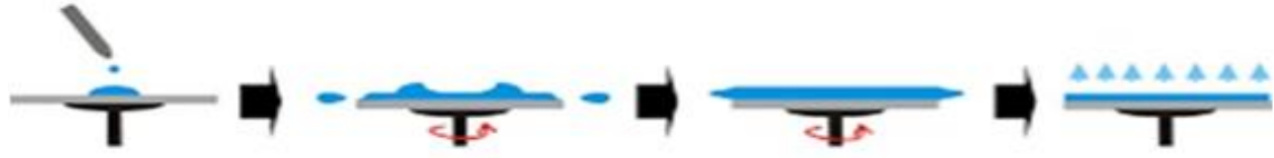
الشكل (7.II): رسم تخطيطي يوضح طريقة الطرد المركزي.
