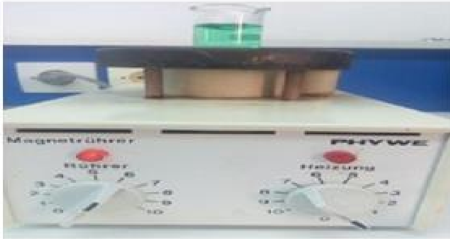
الشكل (III.2): الخلاط المغناطيسي.
