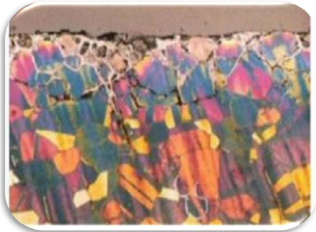
الشكل(1-3) : صورة للتآكل ما بين الحبيبات
