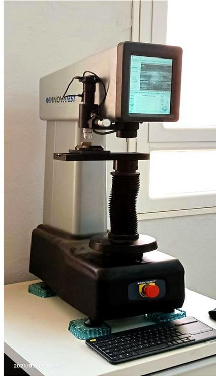
Figure II.9: Microduromètre de type INNOVAYEST
