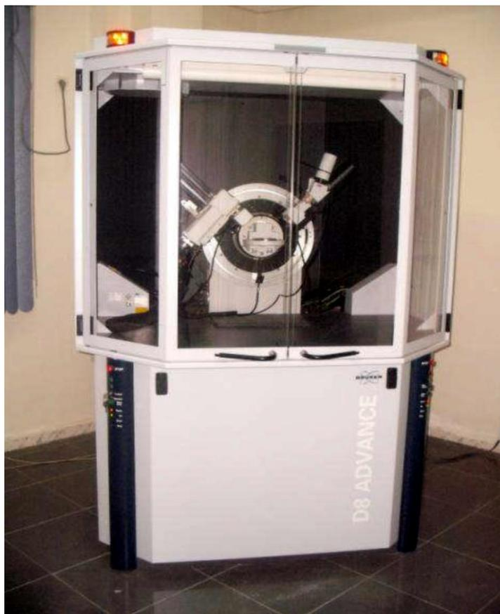
**Figure II.10:** Diffractomètre automatisé type ADVANCE 08
