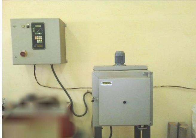
**Figure II.3:** Four électrique de traitement thermique type Nabertherm
