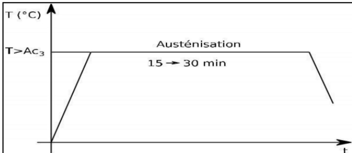
Figure I.12 : Le cycle de la trempe [17].
