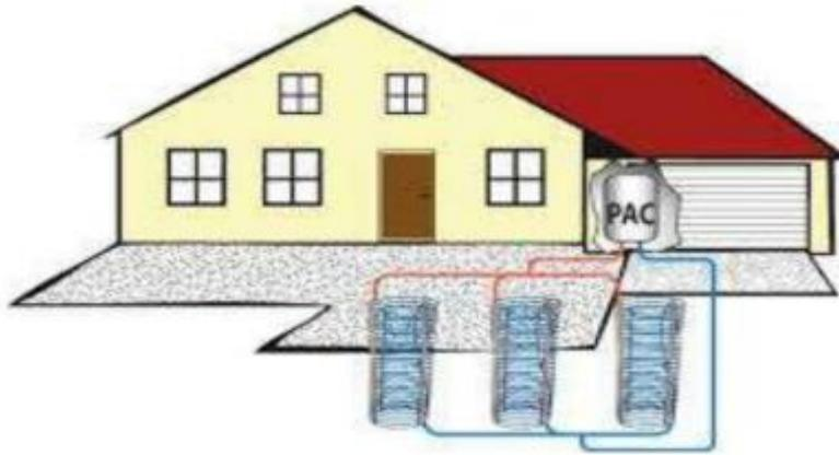
**Figure.II.7.**Echangeur spiral [13].
