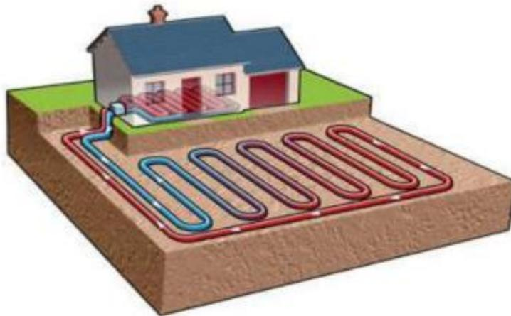
Figure.II.8.échangeur horizontal [13].
