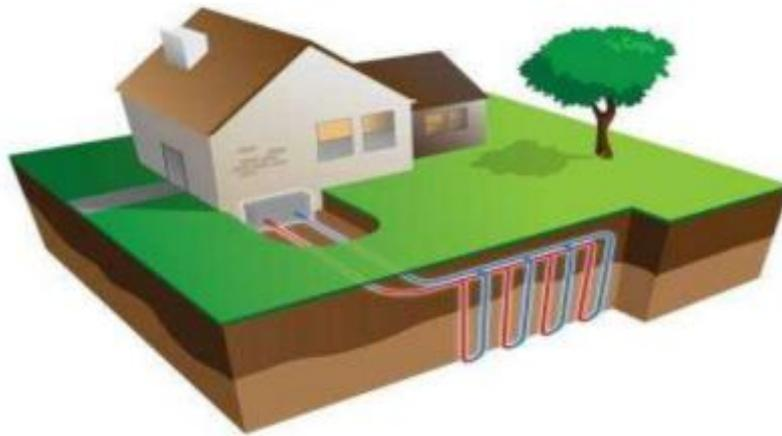
**Figure.II.6.**Echangeur Serpentins [13].
