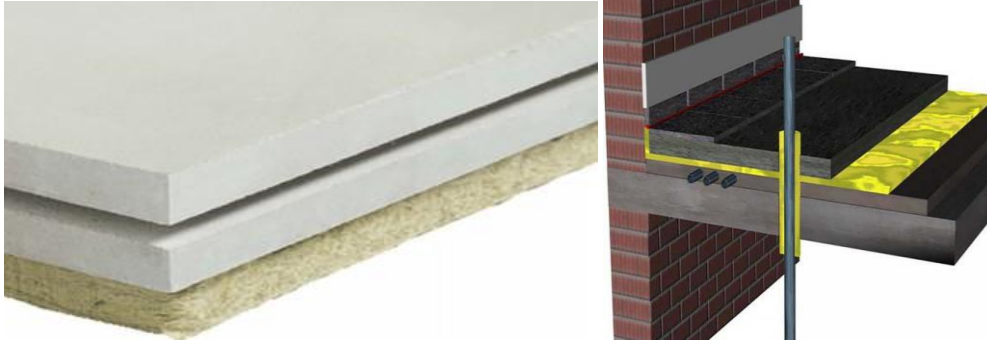
Fig.II.34. Détail de la chape flottante
