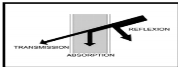
Fig.I.35. Montre les chemins de la Réflexion, absorption et transmission du son.
