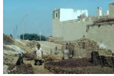
صورة 42: صناعة الطوب اللبني
