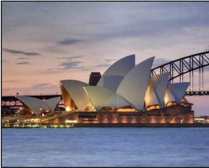
**Figure A.6:** l'opéra de Sidney les coques est en béton armé recouvert de tuiles miroitantes encéramique ( archiexpo.com)
