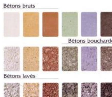
Fig.6 : Différentes teintes et textures du béton.
