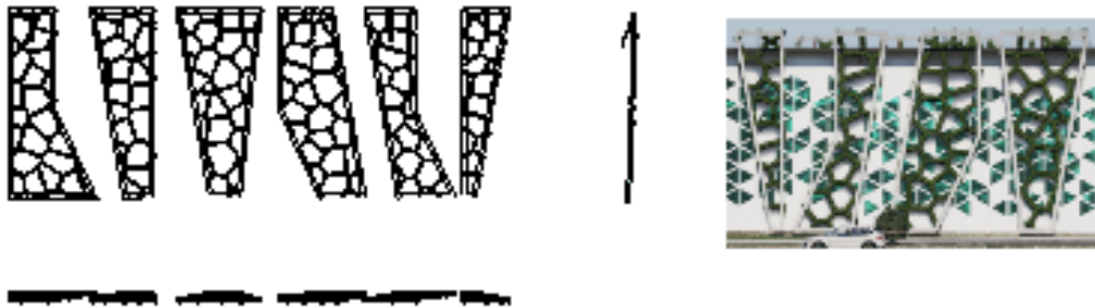
الشكل (III-21): تفاصيل الغلاف المستخدم في الواجهات. المصدر: (الباحثة، 2021).
