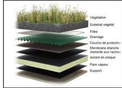
الشكل (III- 26): تفصيل السقف الأخضر النباتي
